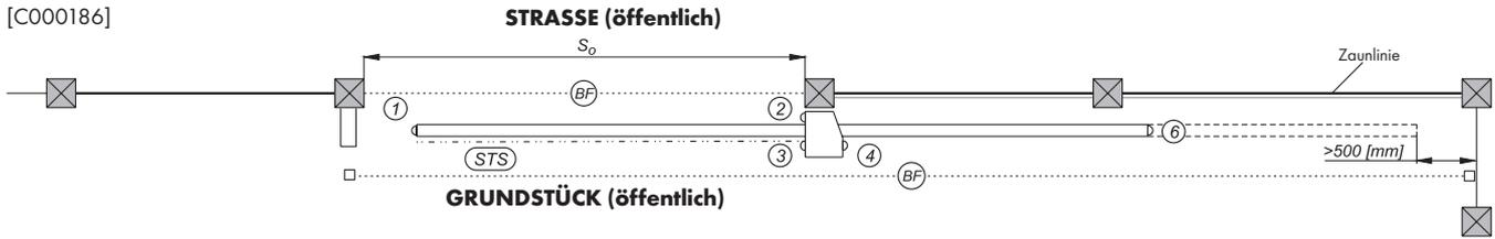
[C000138] RICHTLINIEN FÜR DIE MONTAGE EINES SCHIEBETORES BEI DEM LICHTEN DURCHMESSER DER FÜLLUNG IN DER UMZÄUNUNG VON >40 [MM], WOBEI EINE MÖGLICHKEIT BESTEHT, DAS TOR VON DER UMZÄUNUNGSLINIE WEGSCHIEBEN
